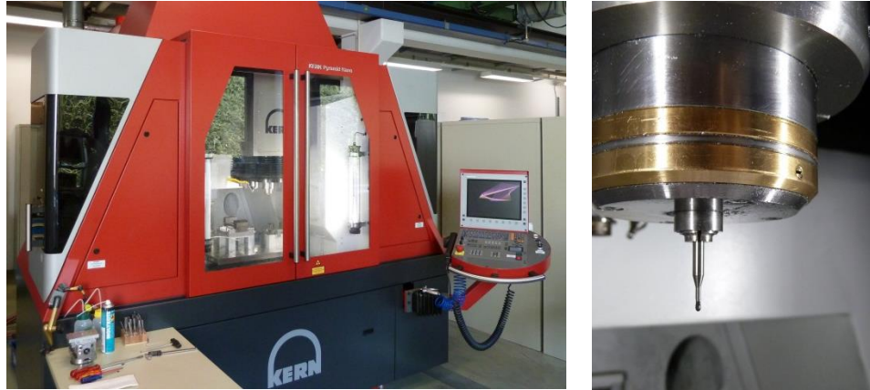
Abbildung 27: Vergleichsversuche mit CBN Fräs Werkzeugen an einer Kern Pyramid Nano
